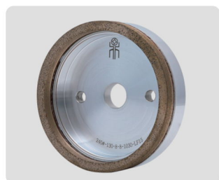
Continuous diamond wheel(E3) Φ150*8*8 Φ130*8*8 (12、22、50) (100#、240#)
