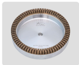
High speed diamond wheel F6 175*d*15*10 80#、100# 175*d*15*6 80-180# 175*d*12*6 140#、180#
